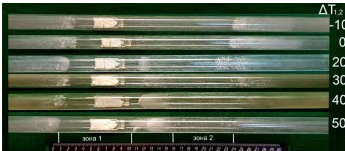
Рис. 5. Фотоизображения ростовой трубки после ряда экспериментов по росту кристаллов п-терфенила в двузонном тепловом поле при различных значениях \Delta T_{1,2} (в К) ( T_1=433 К).
